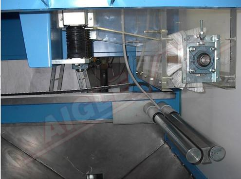
**AIGLE** ha sviluppato diversi impianti di **Floccaggio per Manicotti in Gomma**: si tratta di guaine tubolari con diametri e lunghezze diverse che vengono floccate e poi vulcanizzate. Successivamente, vengono tagliate a strisce ad anello chiuso, per essere così impiegate come cinghie di trasmissione per motori. Il flock ha lo scopo di aumentare la vita della cinghia e di diminuirne la rumorosità. **AIGLE** ha progettato e costruito impianti di floccaggio costituiti da:
