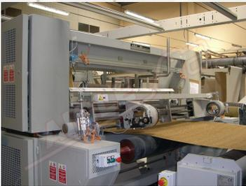
L'unità è utilizzabile sia per spalmatura in aria che su cilindro ed è dotata di un dispositivo motorizzato con indicatori digitali per regolare lo spessore di spalmatura.
