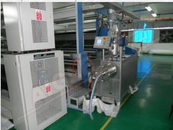
Inoltre, la macchina è dotata di testa serigrafica. Questo sistema di spalmatura offre la possibilità di controllare in maniera ottimale la penetrazione della pasta.
