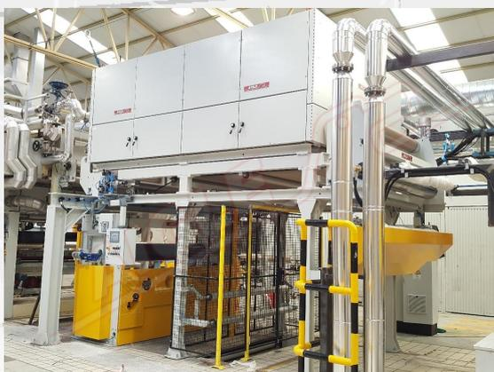
Il gruppo è motorizzato con motore a A.C. dotato di inverter per la sincronizzazione con il resto della linea. È presente un ballerino per la regolazione della velocità del cilindro di stampa, con controllo pneumatico della tensione del tessuto.
