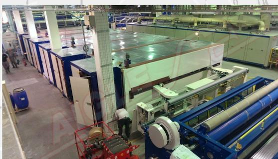
**Struttura del forno**, con porte laterali poste lungo i lati dotate di guarnizioni in gomma siliconata, in modo da permettere un facile accesso all'interno. Sia le porte laterali che la parte superiore sono in pannelli di lamiera zincata contenenti lana di roccia ad alta densità.
