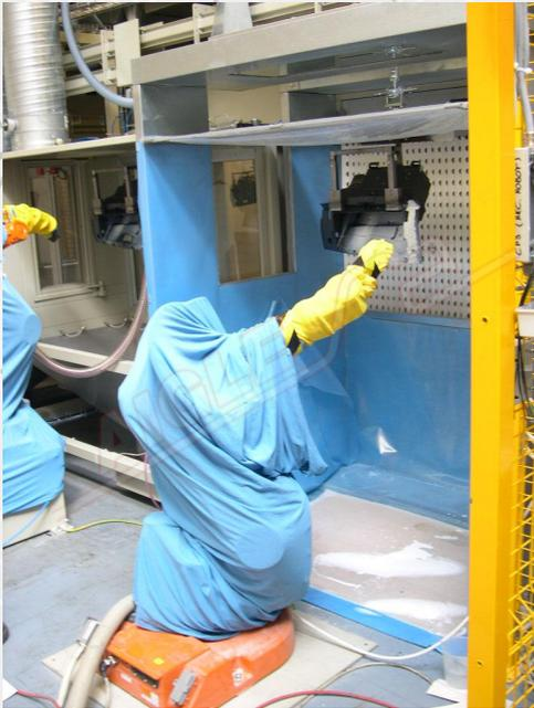
Il sistema è gestito da un PLC per la gestione dei principali parametri di produzione. Il sistema consente anche di impostare ricette su prodotti specifici; i parametri di produzione impostati si possono memorizzare e riproporre successivamente per lavorazioni simili.
