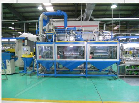
Sezione di distribuzione flock, composta da una tramoggia di floccaggio longitudinale con spazzola rotante. Opposto alla spazzola vi è un telaio a rete, che può essere facilmente rimosso per la pulizia. La velocità di rotazione della spazzola è regolabile ed un sistema motorizzato permette di cambiare la distanza della tramoggia dal profilo.
