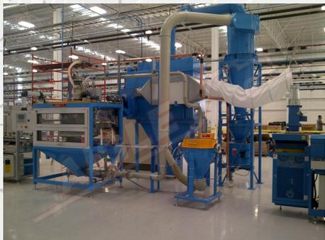
La **Floccatrice mod. F-01-800** può essere utilizzata singolarmente, oppure combinata con due o più moduli in modo da ottenere velocità di floccaggio superiori. È inoltre abbinabile ad una Floccatrice mod. FR/ESP per floccare profili sottosquadra.
