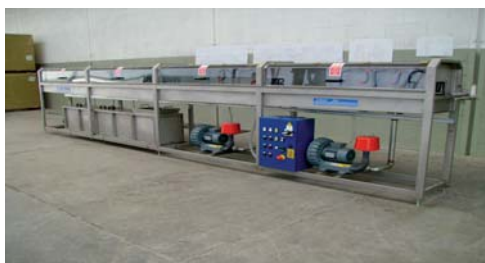
Kühlung und Reinigungsmaschine Cooling and cleaning machine
