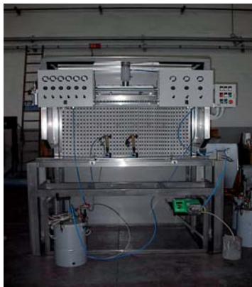
Kabine zum Klebstoffauftrag Adhesive Cabine
