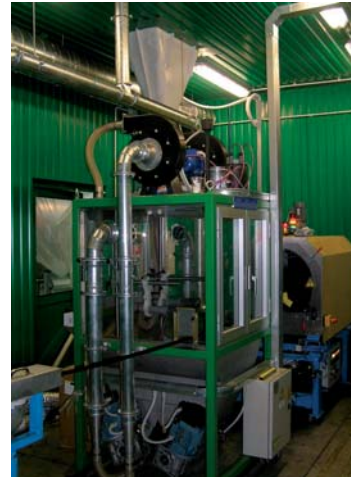
Elektrostatische Pneumatische Beflockung Electrostatic pneumatic machine
