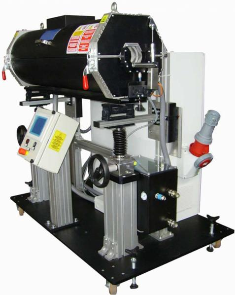
L'Unità di Pre-vulcanizzazione Mod. NIRV-101 è costituita da 6 sezioni. Ciascuna di esse si compone di 2 lampade ad infrarossi. Ognuna delle quali ha una lunghezza di 960 mm. La temperatura di ciascuna zona può essere regolata separatamente attraverso un sistema PLC.
